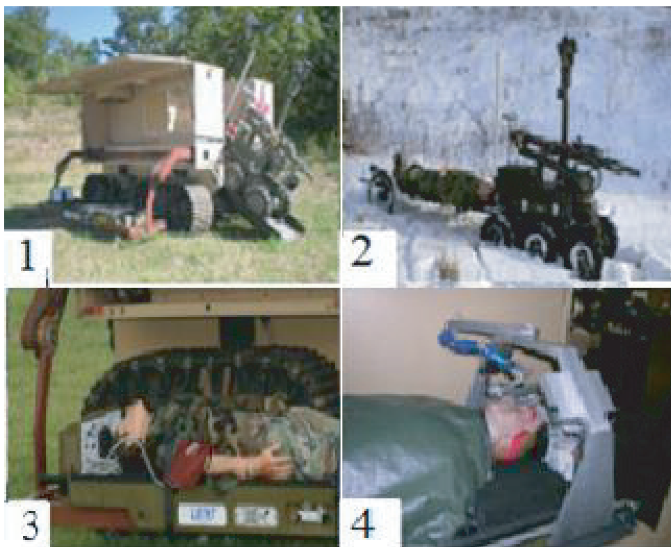
Рис. 1. Поэтапная работа систем REX/REV/LSTAT: 1 – выгрузка REX; 2 – загрузка и перевозка раненого; 3 – перемещение раненого в REV; 4 – контроль жизненно важных показателей раненого с помощью системы LSTAT
