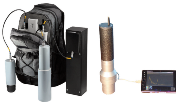
Рис. 2. Спектрометрические комплексы MKS-01A «Мультирад-М» и MKS-AT6101C [4, 5]
