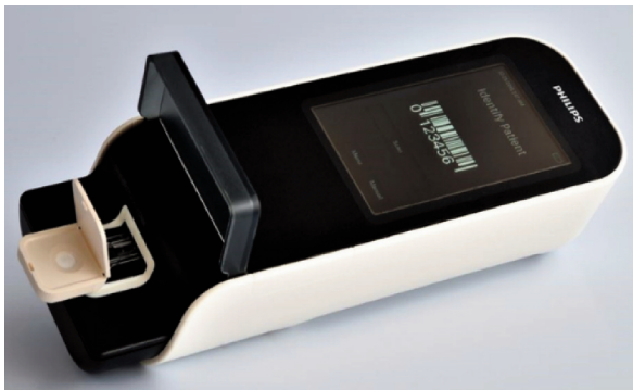
Рис. 4. Компактный анализатор для определения уровня биомаркеров нейротравмы
