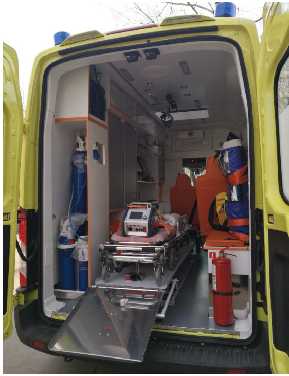
Рис. 4. Размещение оборудования в автомобиле "Ford Transit"
