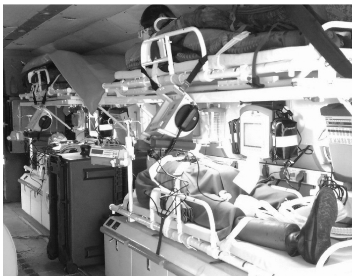
Рис. 3. Аэромобильный медицинский комплекс – медицинские модули вертолётные ММВ.9520.000 в грузовой кабине вертолёт Ми-8МТВ-1 – вид сзади
