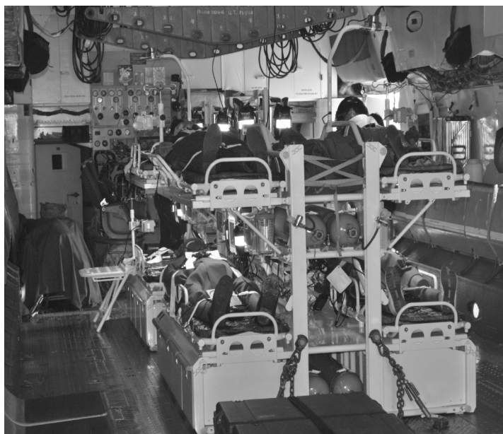
Рис. 1. Аэромобильный медицинский комплекс – медицинский модуль самолёта Ил-76МД – вид сзади
