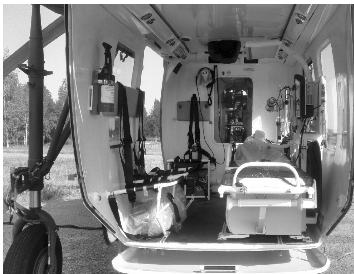
Рис. 2. Аэромобильный медицинский комплекс – медицинский модуль вертолётный ММВ.9520.000 в вертолёте Ка-226.80 – вид сзади
