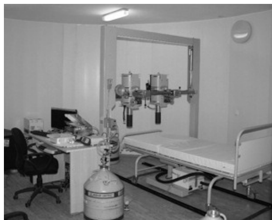
Рис. 2. Спектрометрическая установка СИЧ-МР с тремя полупроводниковыми детекторами (два – слева, один – справа в коллиматоре)
