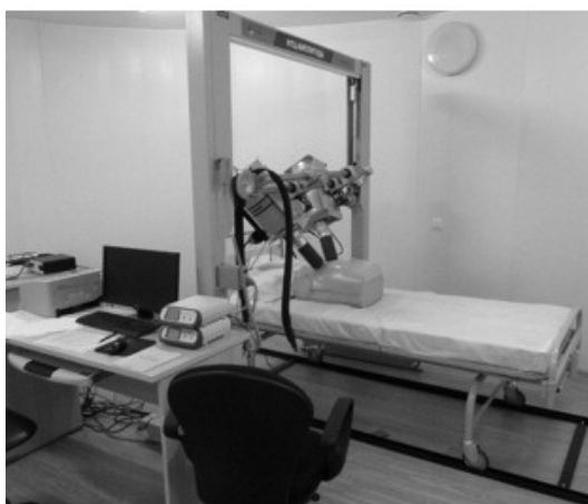
Рис. 2. Спектрометрическая установка СИЧ-МР с тремя полупроводниковыми детекторами (два – слева, один – справа в коллиматоре)
